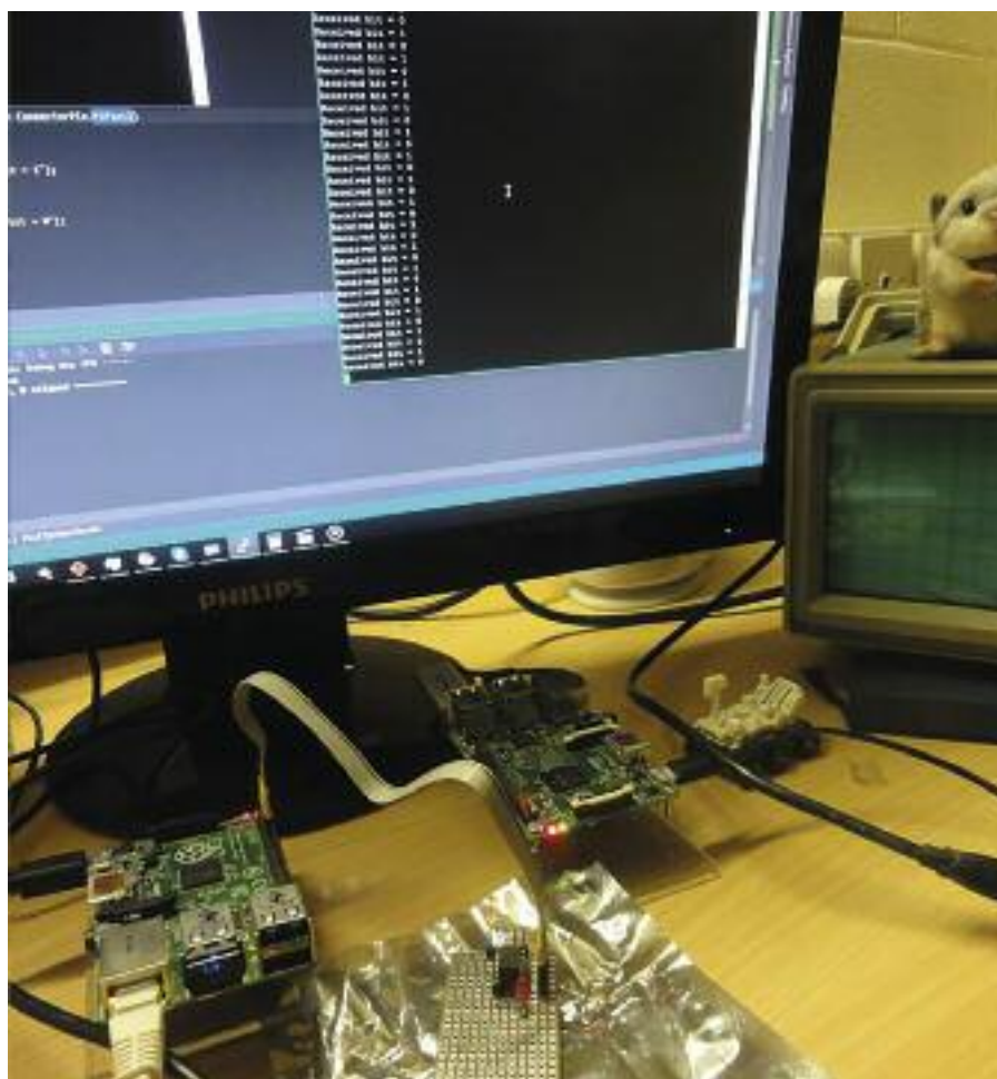
Fig. 3: Topologia de test: două noduri și un controller legat la un LED
